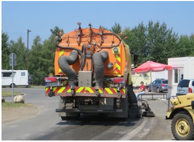
Vakuumsugning av permeabel asfalt
