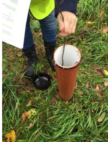
Bild 17-18 rökpatron fasttejp på tumstock (17) och rökpatrontest på snöre i ett luftningsrör (18).
