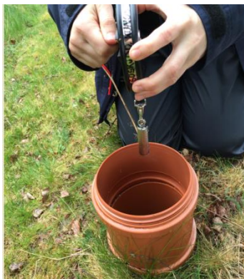
Bild 8 Mätning med klucklod i grundvattenrör
