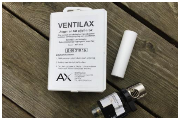
Bild 6 Rökpatron och gaständare.
