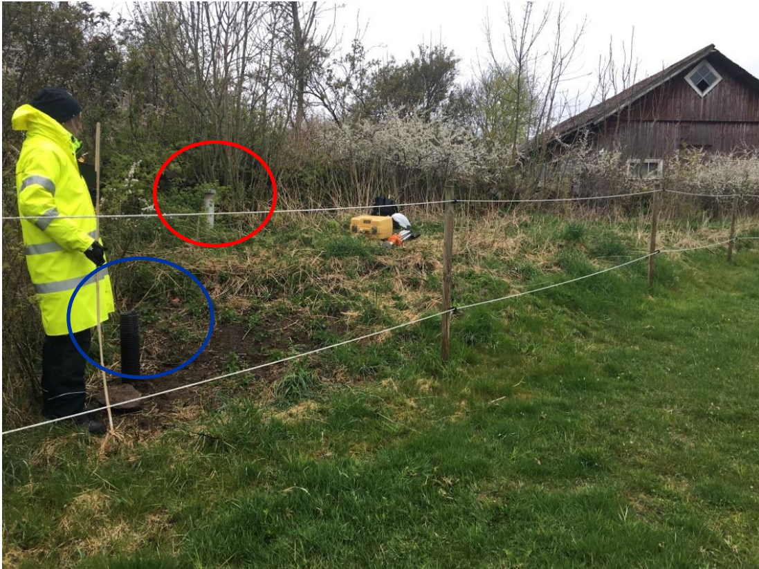
Bild 35 Infiltration. Blå inringning = grundvattenrör. Röd inringning = luftare.
