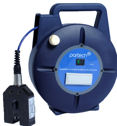
Figur 2. Utstyr for måling av slamdybde (Prosess-Styring AS).
