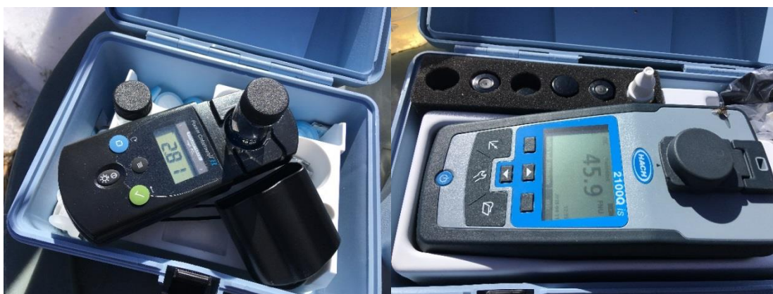
Figur 3. Bilder på den fältutrustning som användes. Portabel turbiditetsmätare HACH 2100Q samt Pocket Colorimeter II från Hach.
