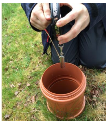
Bild 8 Mätning med klucklod i grundvattenrör
