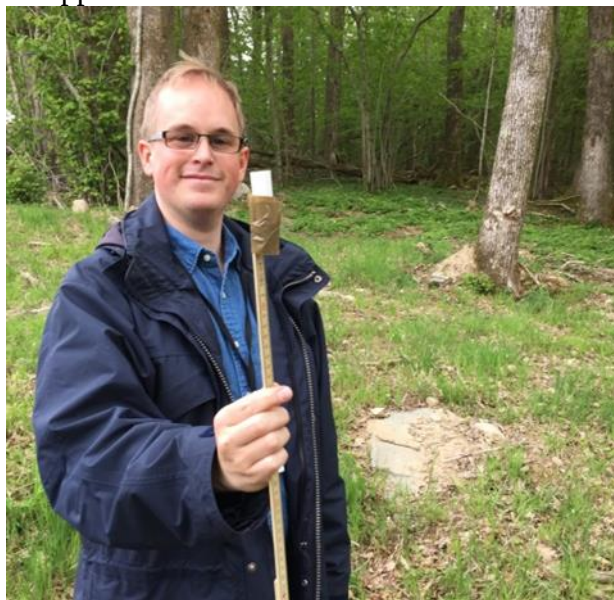
Bild 17-18 rökpatron fasttejpad på tumstock (17) och rökpatrontest på snöre i ett luftningsrör (18).
