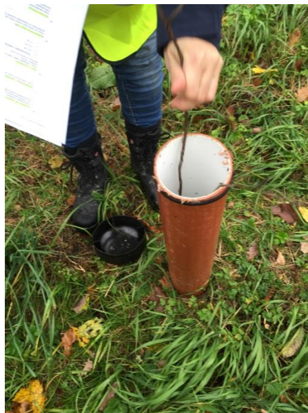
Bild 17-18 rökpatron fasttejpad på tumstock (17) och rökpatrontest på snöre i ett luftningsrör (18).
