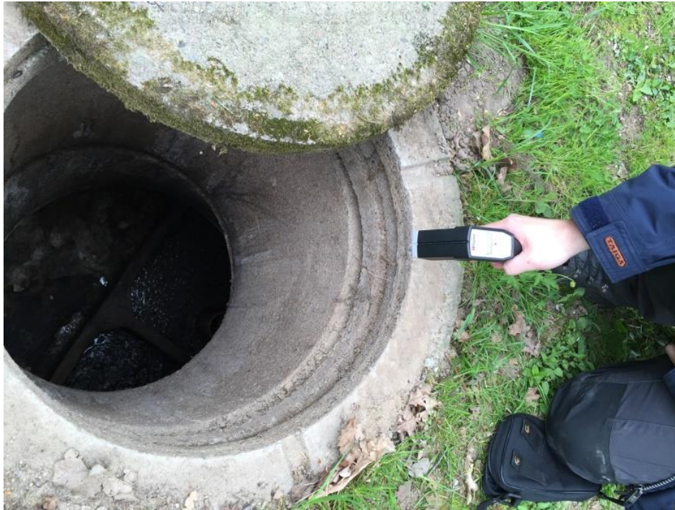
Bild 12 Temperaturmätning i slamavskiljare
