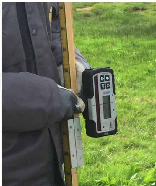
Bild 11 Mottagare med mätsticka för planlaser
