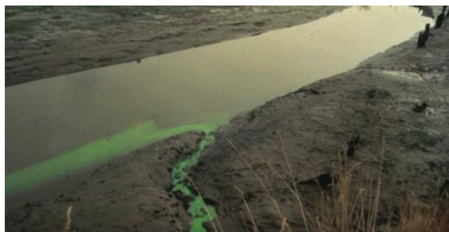
Figur 5 Användning av färg för att spåra avloppsvatten (från you-tube video av Washington State)
