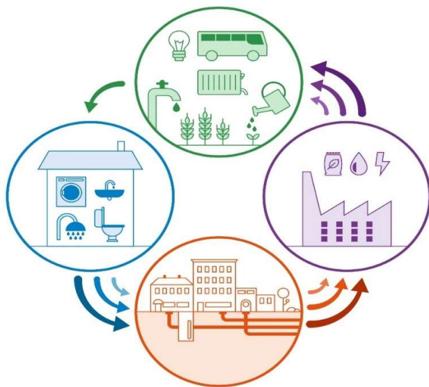
Figur 2.1: Källsorterande avlopp där flera separata flöden leds från hushållet till resursverk för återvinning av olika resurser.
