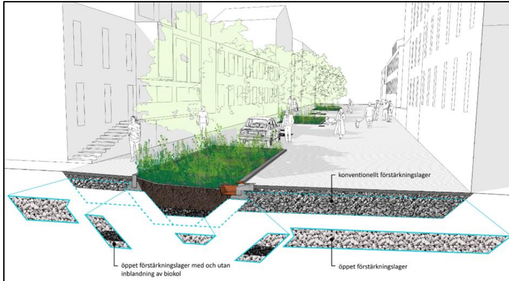
Figur 2. Under körbana och vegetationsyta i kvartersgator har det konventionella förstärkningslagret bytts ut till öppet förstärkningslager (Edge).
