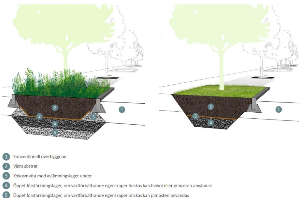
Figur 4.6.1. Illustrering av en vegetationsyta och konstruktion, en med högre krav och en med lägre krav. Illustration: Martin Vysoký, Mia Border, Martin Brattström, Ida Linnersten, Adam Linde och Susanne Sixtensson, Barbora Lišková. Edge (2019)
