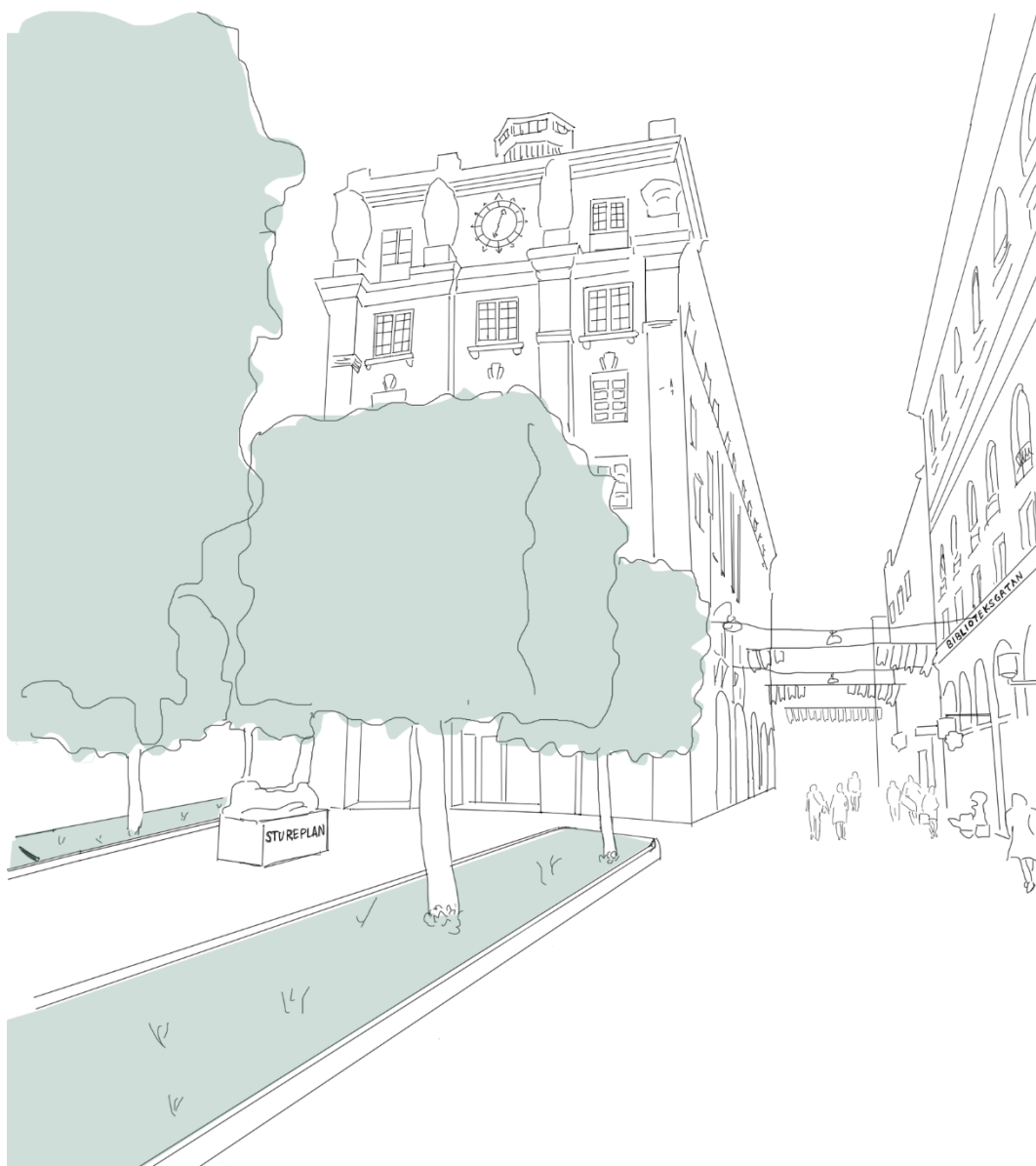
Figur 6.1.3. Illustrering av regnbäddar vid Stureplan sydväst om Birger Jarlsgatan. Regnbäddarna är placerade på Stureplan för att stoppa dagvatten från Birger Jarlsgatan (vänster om regnbäddarna på bilden) att nå Biblioteksgatan som syns till höger på bilden. De hårdgjorda ytorna är i dränerande beläggning för att ytterligare minska mängden dagvatten på ytan.
