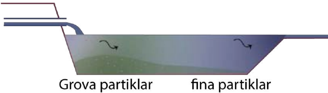
Figur 6. Sedimentering av de grövsta partiklarna sker när vattnets hastighet har avtagit, ju finare partiklarna är desto längre tid tar det för dem att sedimenteras.
