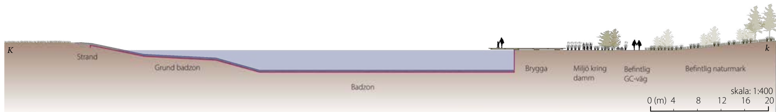
Figur 68. Snitt K-k över baddammen. Baddammen har en grundare zon, men är till största delen 2,5 meter djup, där material kan sedimenteras och inte röras upp igen.
