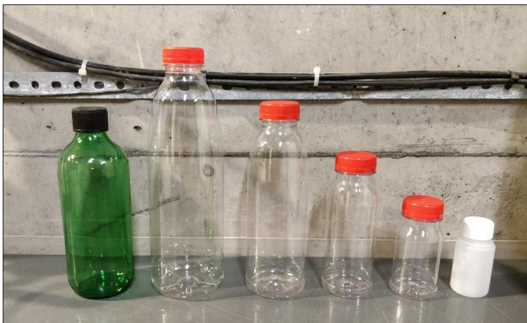
Figur 5: På bilden ser man de olika vattenprovbehållarna. Från vänster till höger kan man se: 1000 ml glasflaska, 1000 ml PET-flaska, 500 ml PET-flaska, 500 ml PET-flaska, 100 ml PET-flaska och 60 ml PET-flaska.
