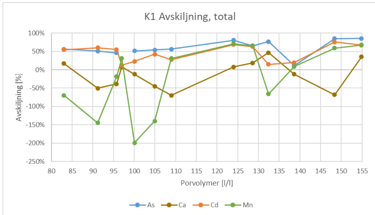
Figur 16: Visar den totala procentuella avskiljningen av fyra element för vattnet från K1 i relation till antal passerade porvolymmer. Avbrott på linjen betyder att provvärdet för elementet i fråga utesluts.
