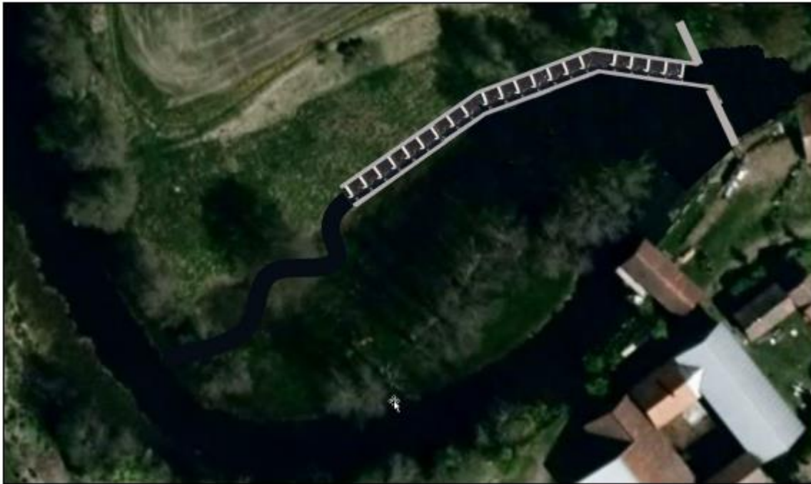
Figur 42 Förslag på slitsränna vid Rosta kvarndamm ( (Tyréns, 2020).
