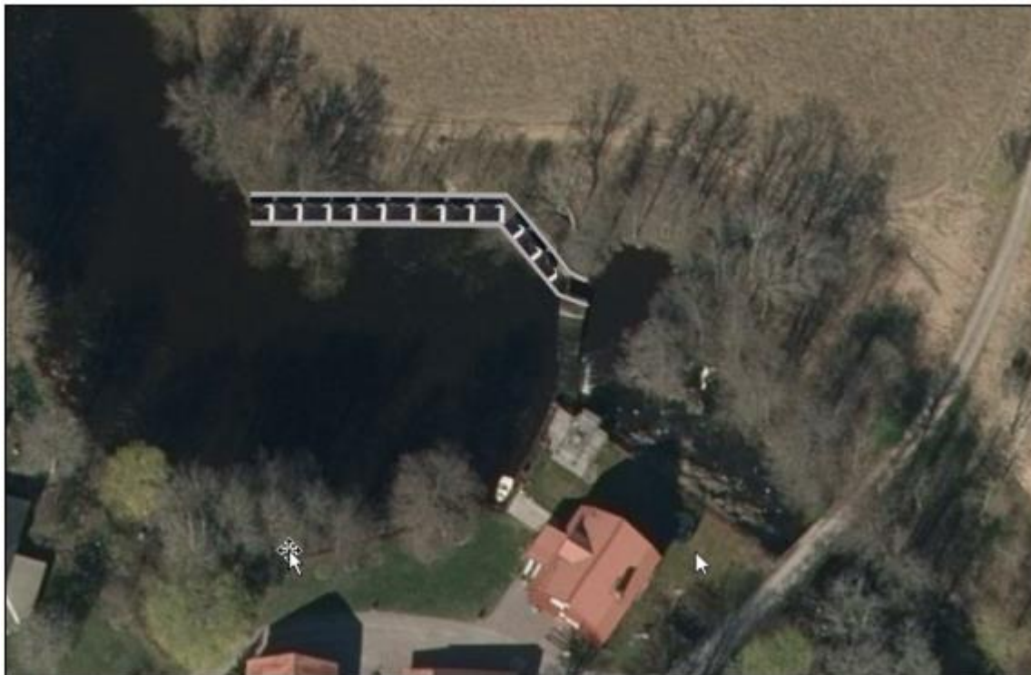
Figur 43 Förslag på slitsränna vid Dragbykvarn illustreras (Tyréns, 2021).
