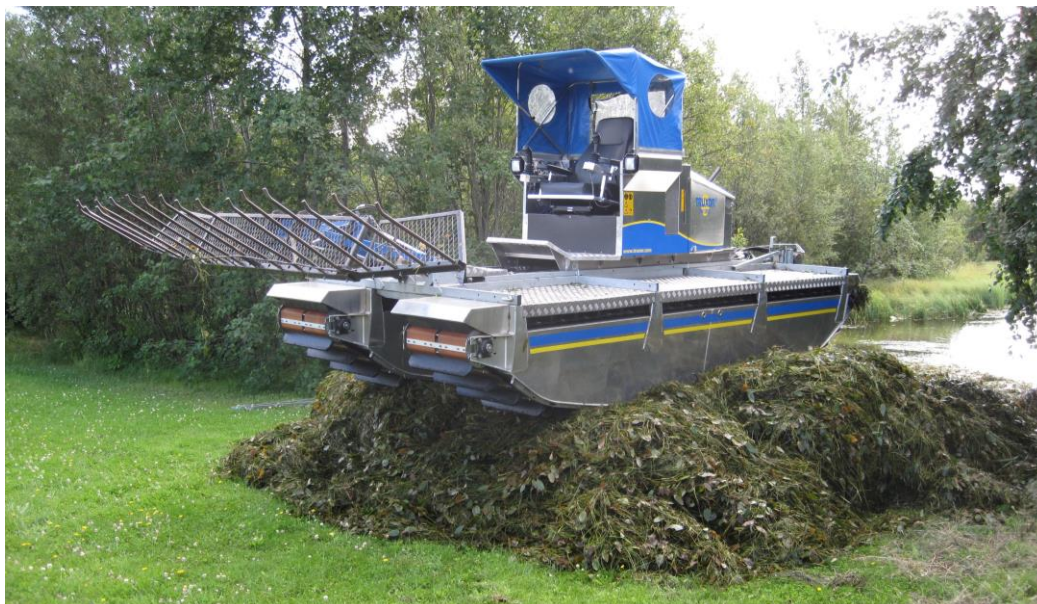
Figur 18. Amfibiemaskiner är ofta att föredra i stora dammar. Denna typ av maskin kan användas för att utföra alla underhållsarbeten i dammen. Vassräfsan kan exempelvis användas för att samla upp och avlägsna omfattande algbloomingar. Bilden är från Dorotea Mekaniska AB.
