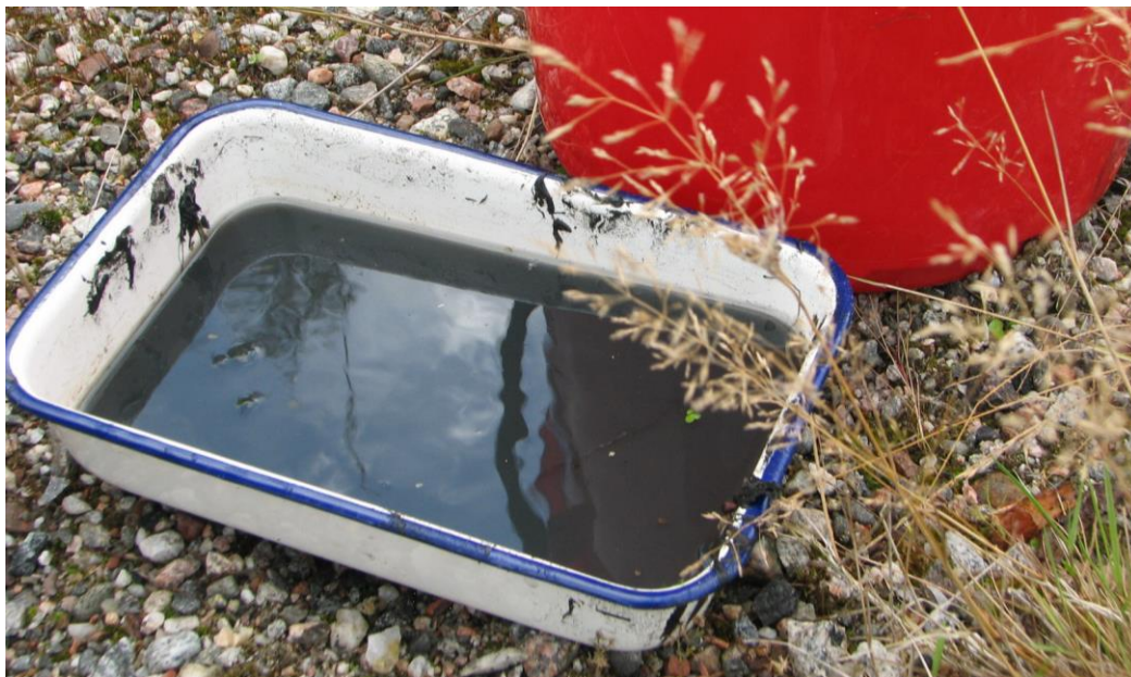
Figur 10. Sedimentens struktur varierar. Det svarta finslammet återfinns ofta vid utloppet där finare partiklar sedimenterar. Sediment som består av små partiklar med hög organisk halt fastlägger föroreningar effektivt. Foto: SGI
