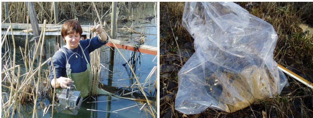
Figur 31. Sedimentprov kan tas med en ekmanhuggare (t.v.). Det upptagna provet kan förvaras i gastäta plastpåsar (t.h.). Foto: SGI.
