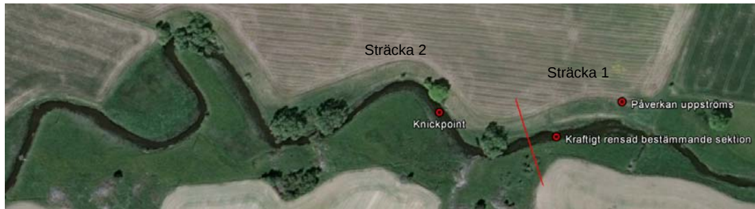
Figur 7-7. Exempel som visar hur variablerna Påverkan uppströms, Kraftigt rensad bestämmande sektion och Knickpoint kan användas. Vattnet rinner åt höger i bild och sträckavgränsningen visas med en röd linje. På sträcka 1 finns en kraftigt rensad bestämmande sektion vilket medför att en erosionsprocess startat på sträcka 2 (head cut erosion). Den bestämmande sektionen markeras som ett punktojekt och noteras på protokollet. Eftersom påverkan inom sträcka 1 har betydelse på morfologin på sträcka 2 ska också Påverkan uppströms noteras. På sträcka 2 finns en knickpoint som visar hur långt upp erosionspåverkan skett. Knickpointen noteras också som punktojekt samt på protokollet. Variablerna ska underlätta utvärderingen av biotopkarteringen och i detta exempel kan man se att det är troligt att rensningen av den bestämmande sektionen har orsakat erosion på sträcka 2, men också att erosionen inte påverkat hela sträckan då knickpointen fortfarande ligger nära den bestämmande sektionen.
