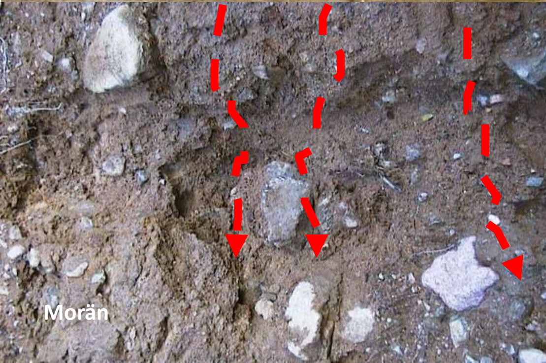
Spårämnesförsök med färgämnen i sand längs danska motorvägar (Jensen 2004).
