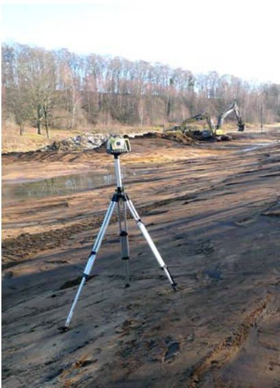
Ett laserinstrument på stativ gör att man själv lätt kan väga av ett område.
